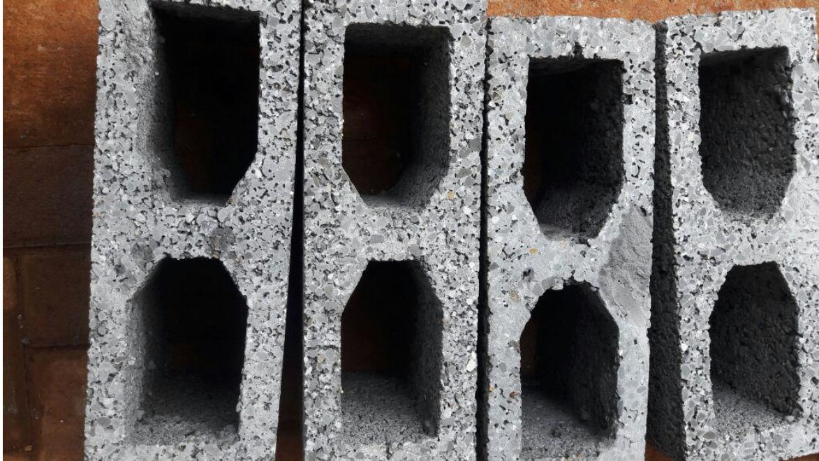
Blocos fornecidos pelo Eng. Roque (trazidos da fábrica) e retificados antes da ruptura.
