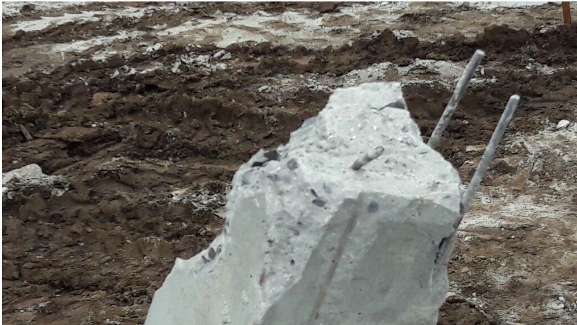
Pilar de (20x40)cm. Nos cálculos constava ferragem de 12,5mm. Foi empregado aço de 8mm.
